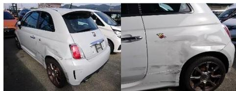
アバルト 500 左後部側面損傷
